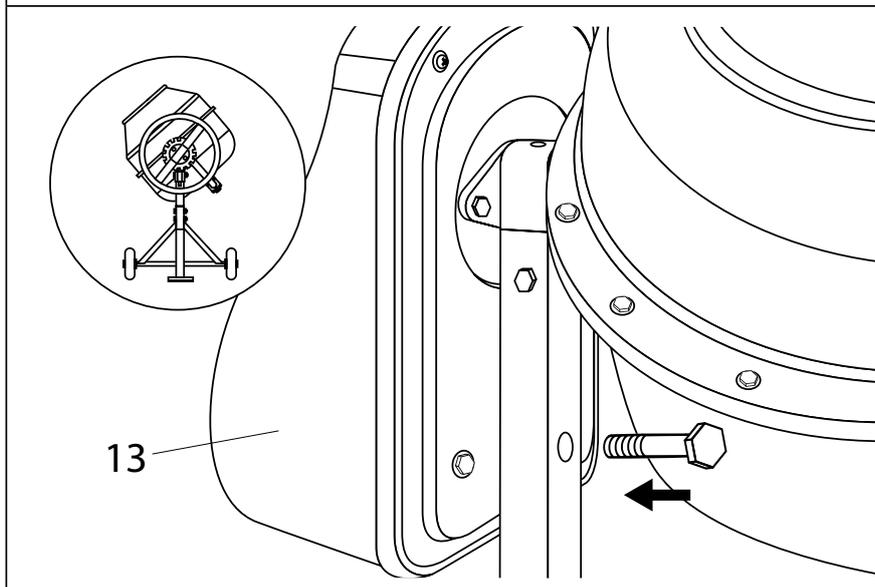
Обърнете барабана, както е показано на рисунката, монтирайте болта M8x55 и шайбата 8 за закрепване на задвижващия блок.
