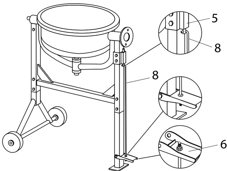
Instalati pe sarcina poz. 8, saiba 6 si uniti cu pedala 6. instalati saiba 5 si fixati sarcina cu doua piulite M5 asa cum este aratat in imagine. uniti sarcina la partea blocului de fixare 5.
