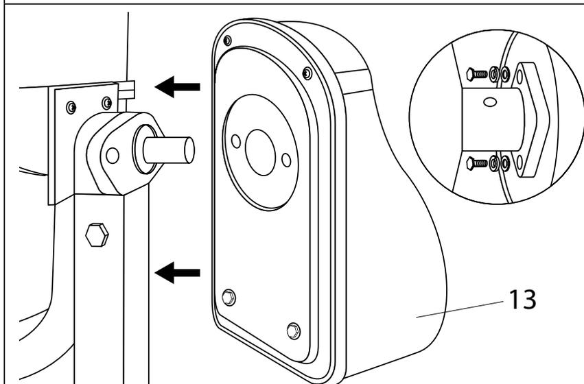
Присъединете задвижващия блок поз. 13 и го закрепете с болтове M8x25, със застопоряваща шайба 8 и шайба 8.
