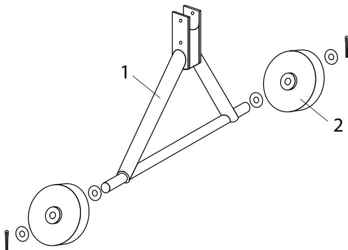
Instalati pe axa suportului de roti poz.1 saiba 27, apoi roata poz. 2 si inca o saiba 27. Introduceri in orificiile axului pene in asa fel incat, ele sa se afle din partea exterioara a saibei. Scoateti penele, folosind clesti.
