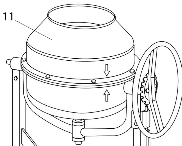
Instalati tamburul superior poz.11 pe cel inferior in concordanta cu sagetile aflate pe ele, fixati cu bolturi.
