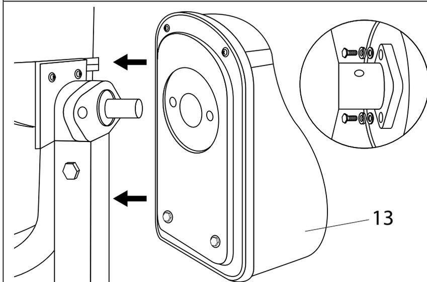
Uniti cablul poz.13 si fixati cu bolturi m8x25, saiba Grower 8 si saiba 8.
