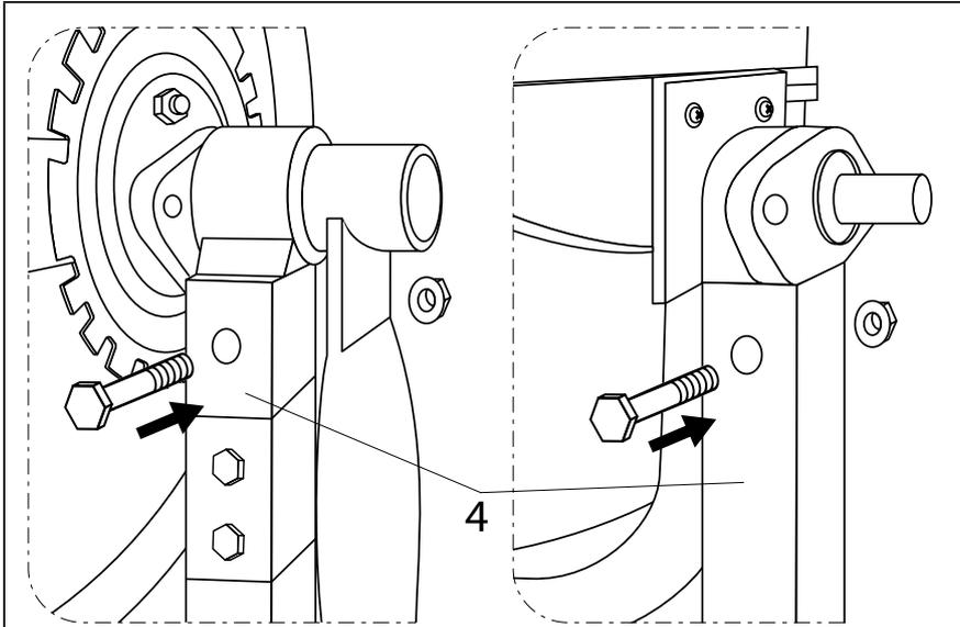
Установить болты М8×65 и закрепить опоры траверсы на раме поз. 4 гайками М8, как показано на рисунке.
