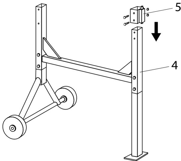
Pentru modelele Cm140, Cm160, Cm180, Cm200, Cm220: Instalati blocul de fixare al tamburului poz.5 pe rama poz.4 si fixati cu bolturi m8x65 si piulite m8.
