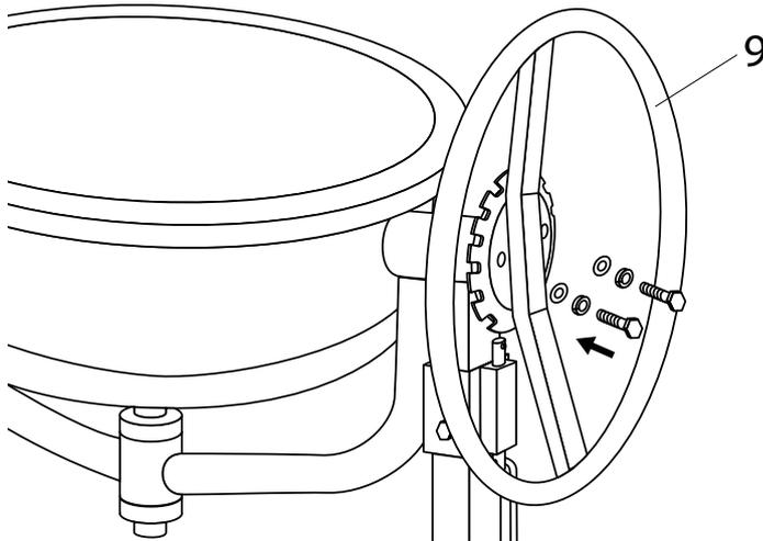
Установить штурвал поз. 9, закрепить болтами М8х16 с шайбами-гровер 8 и шайбой 8.
