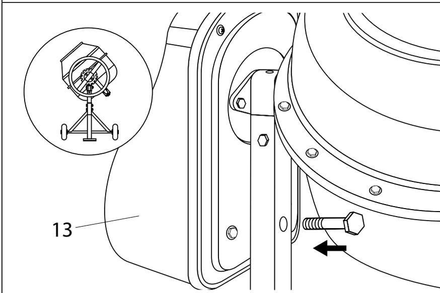
Повернуть барабан, как показано на рисунке, установить болт М8×55 и шайбу 8 для крепления привода.
