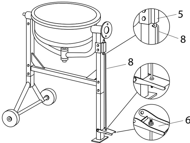
Установить на тягу поз. 8 шайбу 6 и присоединить к педали 6. Установить шайбу 5 и закрепить тягу двумя гайками М5 в порядке, как показано на рисунке. Присоединить тягу к штоку блока фиксации 5.
