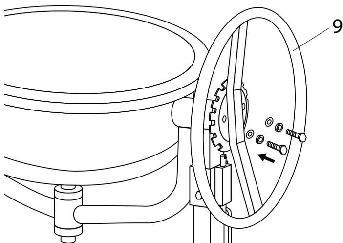
Instalati volanul poz.9,, fixati cu bolturi m8x16 cu saibe Grower 8 si saiba 8.
