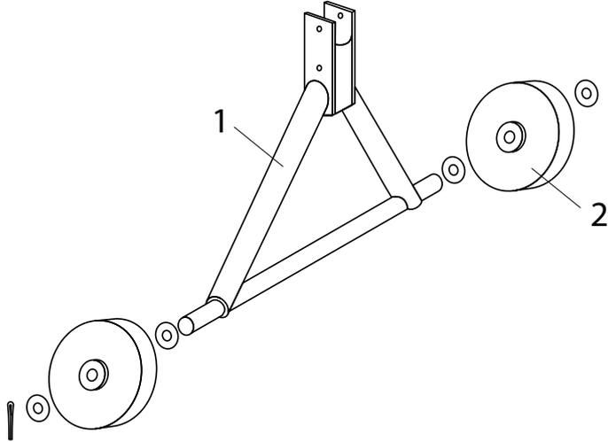
Установить на оси колесной опоры поз. 1 шайбу 27, затем колесо поз. 2 и еще одну шайбу 27. Вставить в отверстия оси шпильки таким образом, чтобы они находились с внешней стороны шайбы. Извлечь шпильки, используя плоскогубцы.
