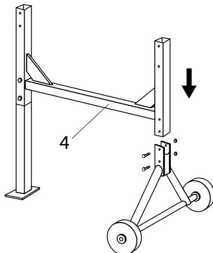
Cuplati suportul cu roti in asamblare cu rama poz. 4 cu ajutorul bolturilor m8x65 si fixati cu piulitele m8.
