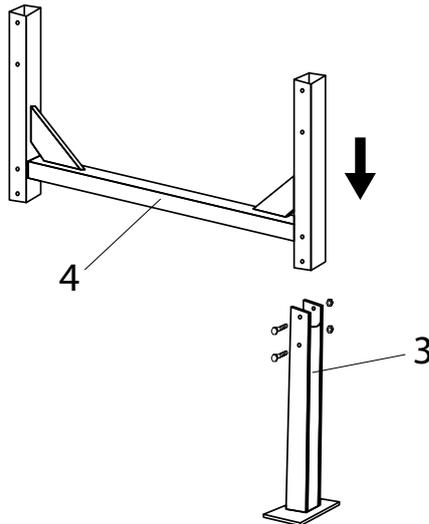
Соединить опору поз. 3 с рамой поз. 4 при помощи болтов М8х65 и закрепить гайками М8. Опора должна быть установлена со стороны рамы с 3 отверстиями (для модели СМ120 – со стороны пружины).
