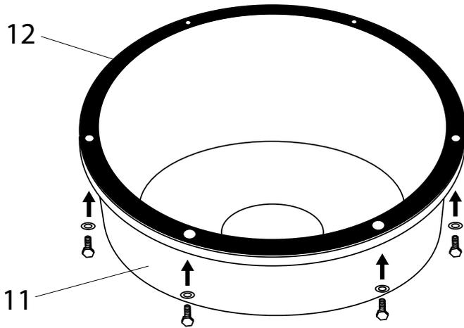
Монтирайте 6 комплекта болтове М6х16 и шайби 6 в отверстия на горния барабан поз. 11, монтирайте изолацията поз. 12, както е показано на рисунката.
