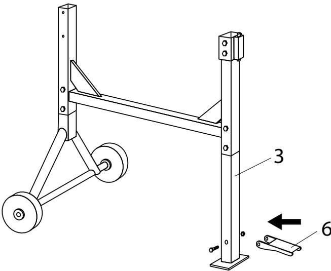
Монтирайте опората поз. 3 педала поз. 6, закрепете го с болтове M8x70 и гайка M8 със заключващ пръстен.
