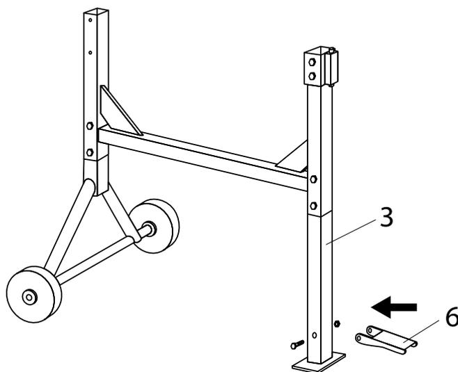
Установить на опору поз. 3 педаль поз. 6, закрепить болтом M8 x 70 и гайкой M8 со стопорным кольцом.
