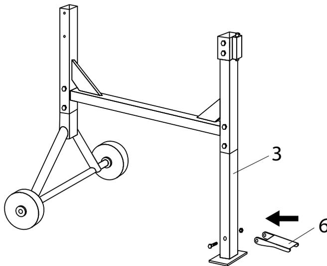
Instalati pe suport poz 3 pedala poz.6, fixati cu bolt m8 x 70 si piulita m8 cu inel de blocare.
