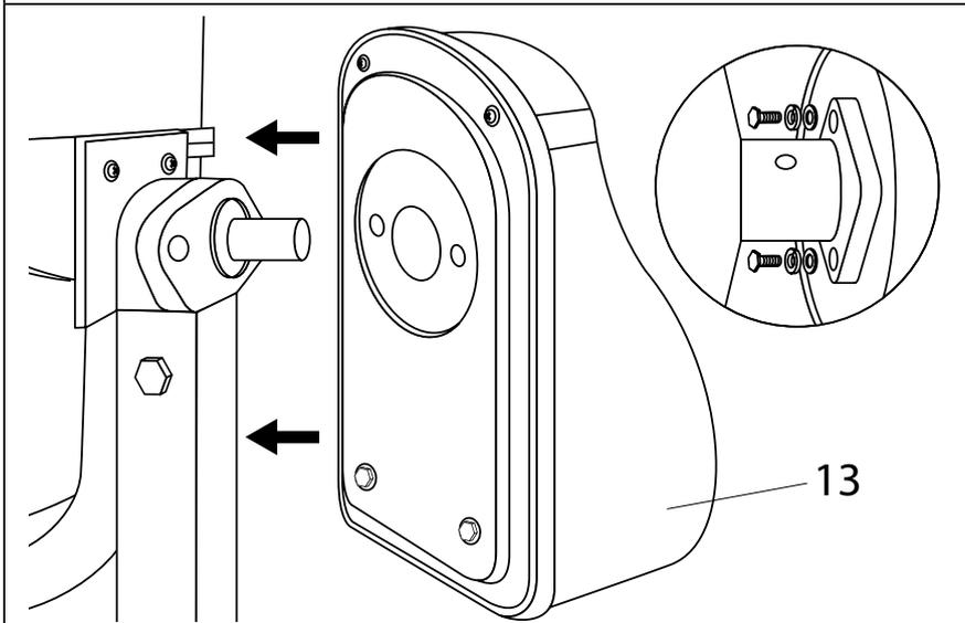
Присоединить привод поз. 13 и закрепить болтами М8×25, шайбой-гровер 8 и шайбой 8.
