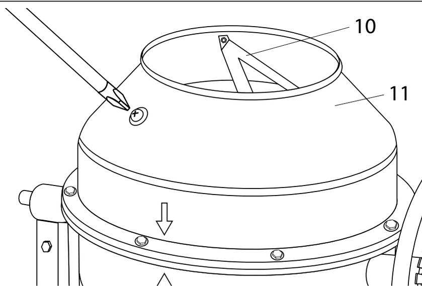
Fixati partea superioara a lamelelor poz.10 pe tamburul superior poz.11 cu ajutorul suruburilor M8×16, saiba 8, piulitelor M8.
