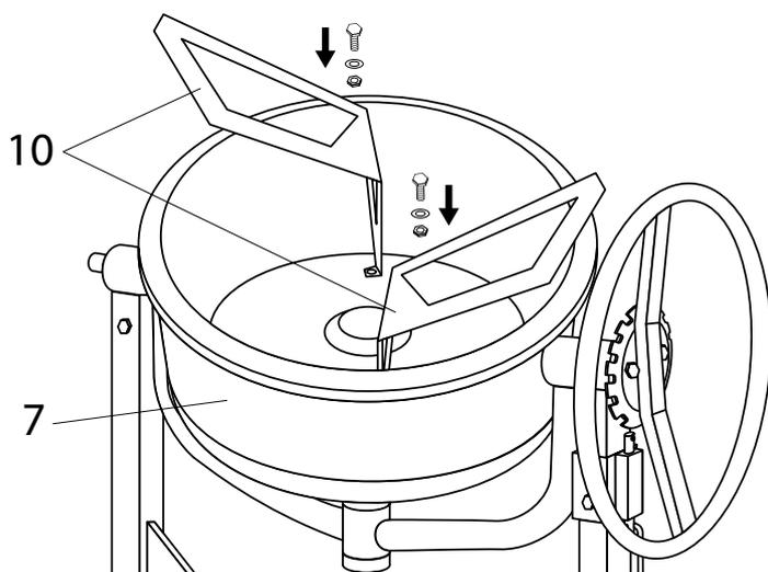
Instalati lamelele pentru amestecare poz. 10 in tamburul inferior poz.7, fixati cu bolturi m8x16 , saibe 8 si piulitele m8.
