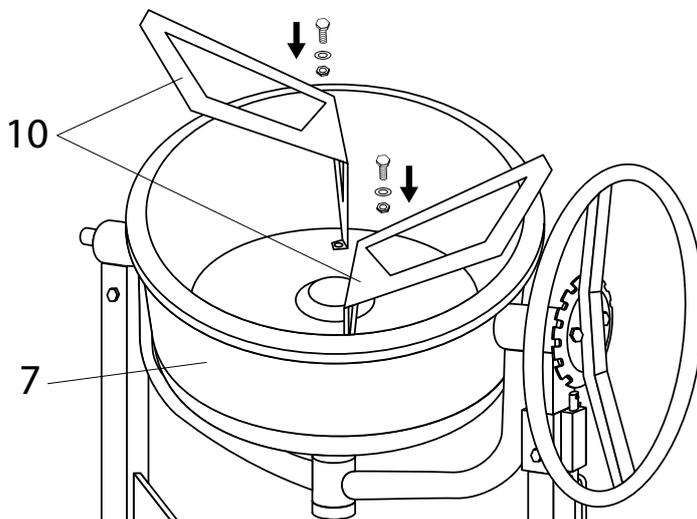
Установить лопасти для смешивания поз. 10 в нижний барабан поз. 7, закрепить болтами М8х16, шайбами 8 и гайками М8.
