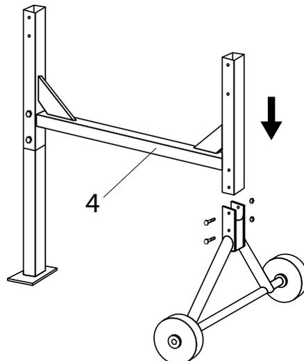
Соединить колесную опору в сборе с рамой поз. 4 при помощи болтов М8х65 и закрепить гайками М8.
