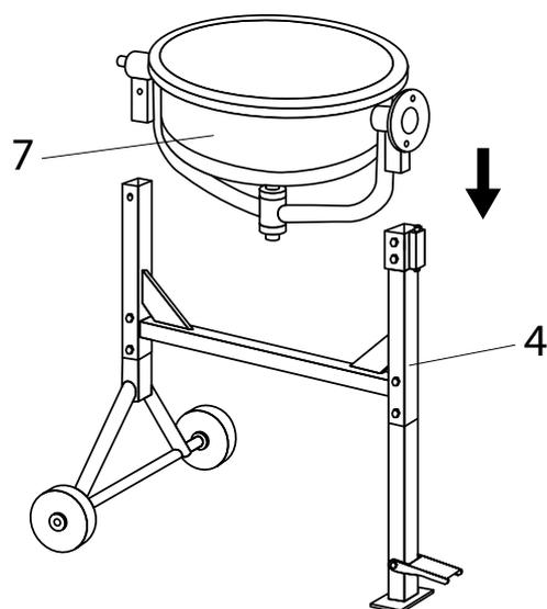
Установить нижний барабан с траверсой поз. 7 на раму поз. 4. Установку выполнять вдвоем.
