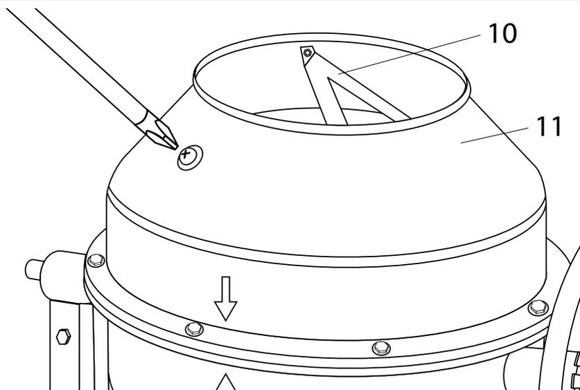
Закрепете горната част на лопатките поз. 10 върху горния барабан поз. 11 с помощта на винтовете М8х16, шайби 8, гайки М8.
