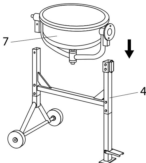
Instalati tamburul inferior cu traversa poz.7 pe rama poz.4. instalarea se va face in doi.
