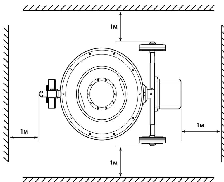
Работа смесителя носит циклический характер с такой последовательностью: загрузка, смешивание, выгрузка. Смеситель следует установить на ровной и твердой горизонтальной поверхности. Рекомендуется включение смесителя при вертикальном положении барабана.
