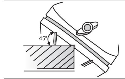
Не прилагайте излишних усилий при нажатии на изделие. Необходимость увеличения усилия свидетельствует о затуплении ножей. Строгание с большим усилием ведет к перегреву изделия и преждевременному выходу его из строя.
