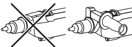
Работа без установленной дополнительной рукоятки ЗАПРЕЩАЕТСЯ
